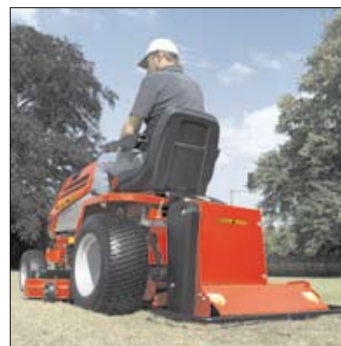
AM-002A Anbau-Vertikutierer in Kombination mit dem ECHOTRAK wird über Keilriemen direkt angetrieben.
