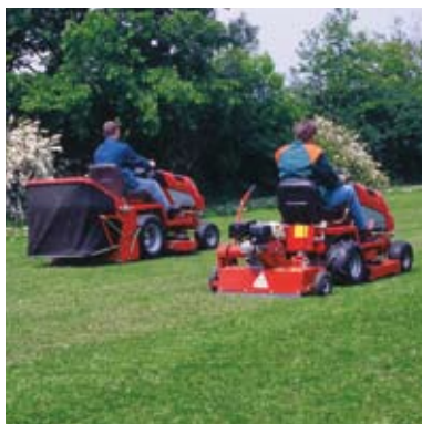
AHV-100HO Anhänge-Vertikutierer für jeden handelsüblichen Rasentraktor.
